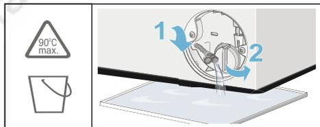
5. Осторожно отверните крышку насоса; остатки воды могут вытечь. Очистите внутреннюю часть, резьбу крышки насоса и корпус насоса. Крыльчатка насоса должна свободно вращаться.
