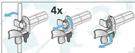
3. Закрепите заглушки. Зафиксируйте заглушки нажатием на стопорные крючки.
