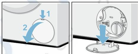
4. Выньте сливной шланг из держателя. Снимите колпачок и дайте воде стечь в подходящую ёмкость. Замените колпачок и поместите сливной шланг в держатель.
