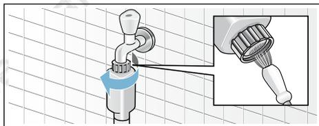
6. На стандартных моделях и моделях с системой «Aqua-Secure» очистите фильтр в задней части машины:
