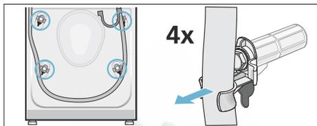
2. Снимите с держателя сетевой кабель. Отверните и снимите все винты четырёх транспортировочных креплений. Удалите втулки.
