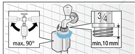
**Указание:** Осторожно откройте водопроводный кран, проверяя герметичность мест соединения. Резьбовые соединения находятся под действием давления системы водоснабжения.
