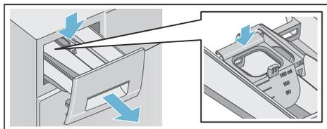
**Указание:** Не используйте дозатор для дозирования гелевых моющих средств и стирального порошка, либо если выбраны программы с предварительной стиркой или с функцией «Время до окончания».
