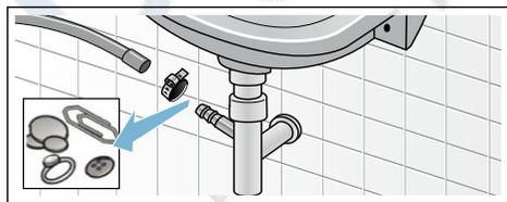
4. Снова подсоедините сливной шланг и закрепите место соединения с помощью шлангового зажима.
