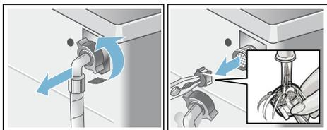
7. Вставьте фильтр, подсоедините шланг и проверьте герметичность соединения.
